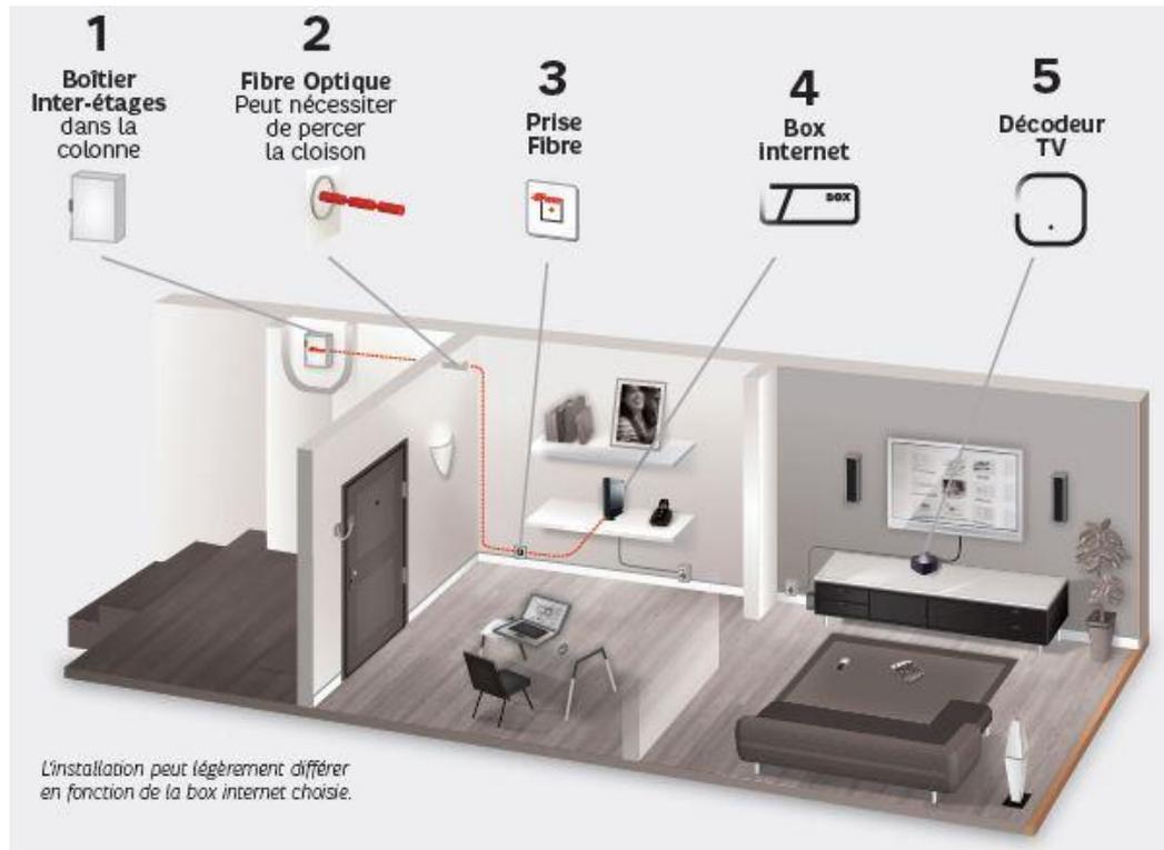
Le technicien va percer un trou au plus près de la porte d'entrée pour faire entrer le câble de la Fibre.
